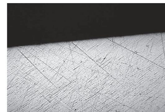
РК японского ножа, заточенного вручную на японских водных камнях. В качестве финишного использовался камень зернистостью 8000. Материал клинка – высокоуглеродистая сталь SIRO-GAMI (белая бумага). Достигнута высокая степень остроты, нож застригивает волос.
